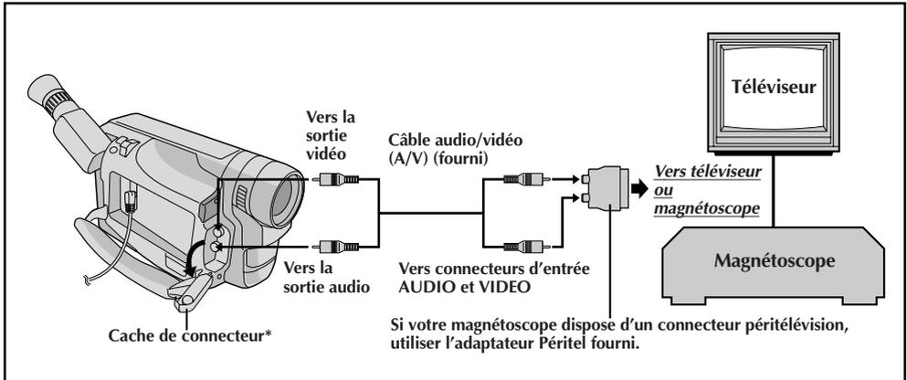
\* Pour raccorder les câbles, ouvrir ce cache.
