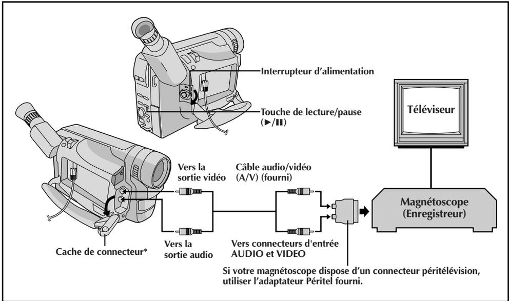
\* Pour raccorder les câbles, ouvrir ce cache.
