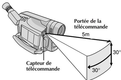
En utilisant la télécommande, bien la diriger vers le capteur de télécommande. L'illustration montre la portée de la télécommande pour l'utilisation en intérieur.
